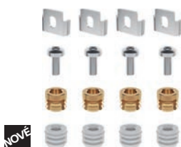
Přichytka pro spodní montáž pro nerezové, fragranitové a tectonite dřezy (Pro spodní montáž do pracovní desky tloušťky 12 - 18 mm) Balení obsahuje: 4x přichytka, 4x šroub, 4x mosaz. rozpěrná matice a 4x plast. rozpěrná matice 133.0730.139
